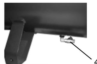
Válvula de dreno de condensados, CPM-10 e CPM-15 montados sobre o reservatório
