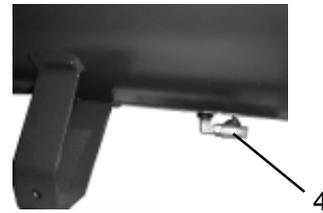
*Válvula de dreno de condensados, CPM-10 e CPM-15*
